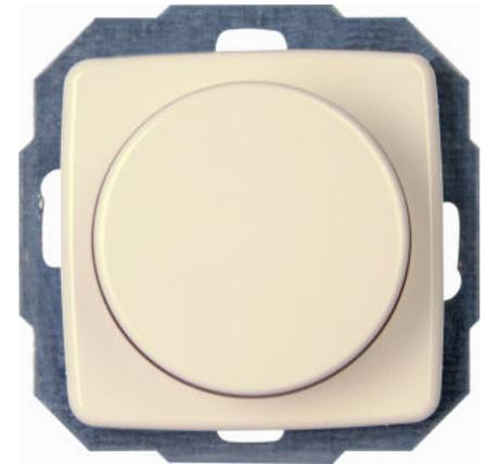
RIVO - Kombigerät - Druck-Wechselschalter, LED-Dimmer. Geeignet für Glühlampen und 230V Halogenlampen, dimmbare LED's sowie NV-Halogenlampen mit konventionellen Trafos (Bitte technische Angaben der Trafo-Hersteller beachten). Einstellbare Grundhelligkeit, mit Softrastung, Phasenschnitt RL 20-250W/VA, LED 3-35W, 230 V~, 50Hz, Farbe: cremeweiß
