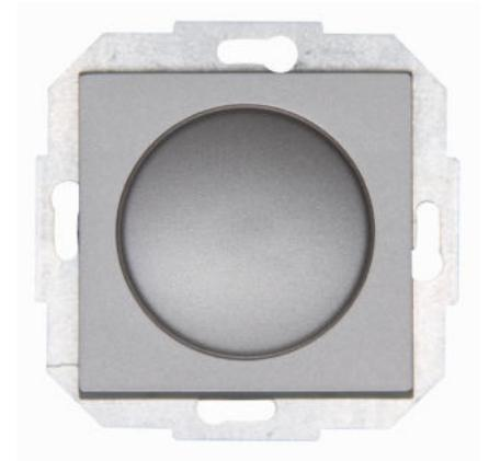
ATHENIS - Druck-Wechsel-Universaldimmer für Glühlampen und 230V Halogenlampen, dimmbare LED's sowie für NV-Halogenlampen mit elektronischen Trafos. Einstellbare Grundhelligkeit, RC10-250W/VA, LED 5-100W, Welle 4mm, mit Mutter und Wellenadapter, Farbe: stahl
